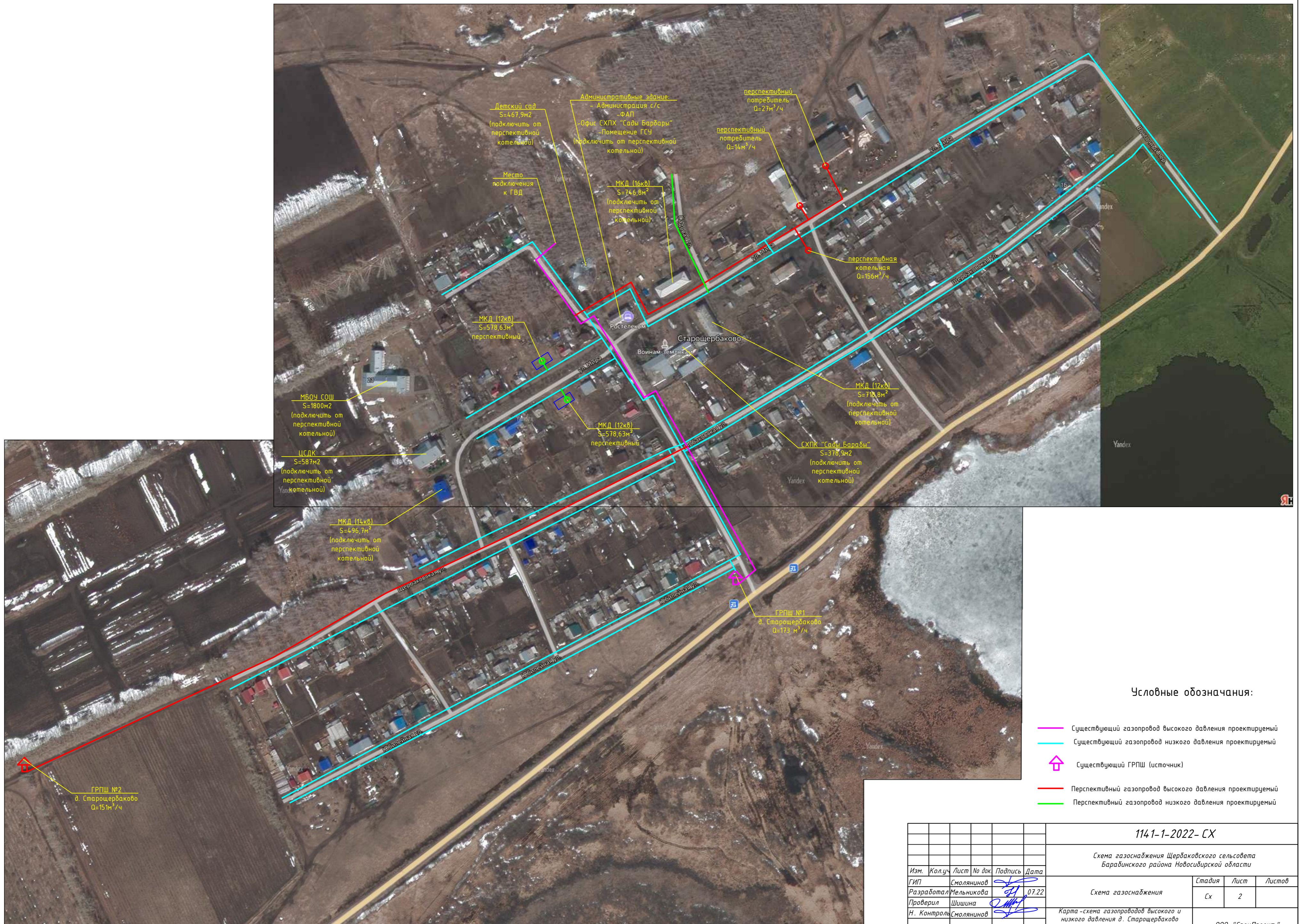
Карта-схема газопроводов высокого и низкого давления д. Старощербаково Щербаковского сельсовета Барабинского района Новосибирской области
