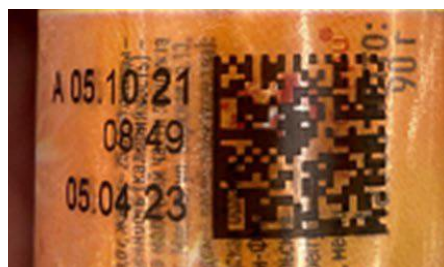
Печать кода маркировки на бликующей/светоотражающей поверхности
