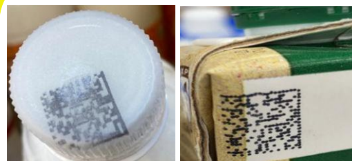
Смещение кода маркировки при печати
