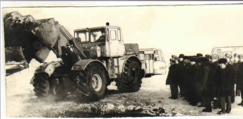
Участники совещания работников областного агропромышленного объединения знакомятся с работой погрузчика на базе трактора К-701, изготовленного рационализаторами совхоза «Таскаевский». Д. Таскаево. 1984 г., автор – не известен. Ф.1ф, оп.1ф, д. 135
